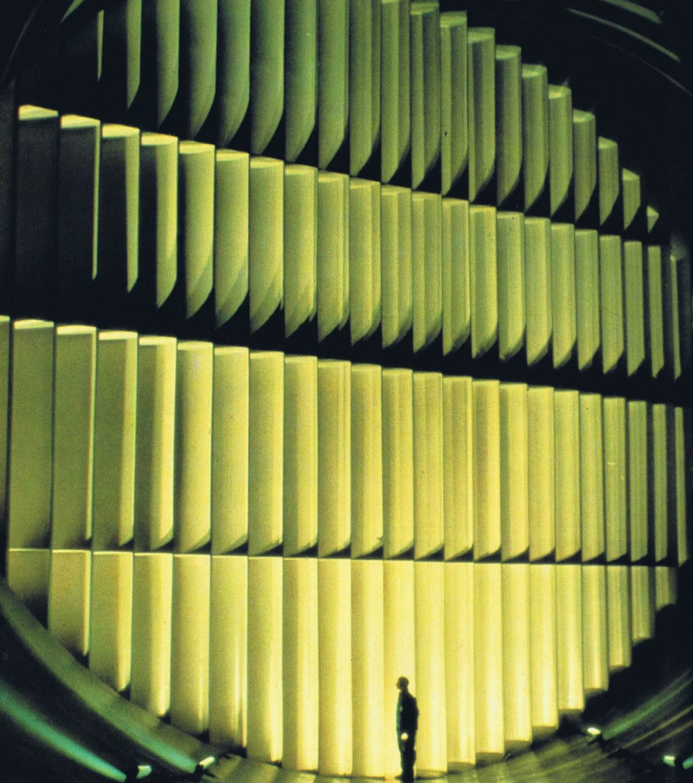
ヨーロッパ最大、風速40m/sまでの風を送り出す風洞実験室。
