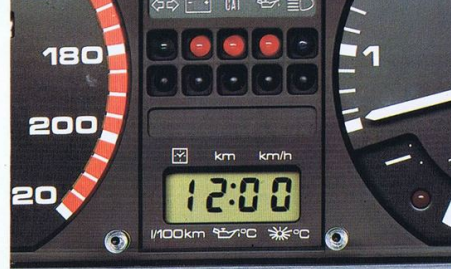
7つの情報を表示するマルチファンクションインジケータ(GTに標準装備)(スピードメーターの値は表示入りません)
