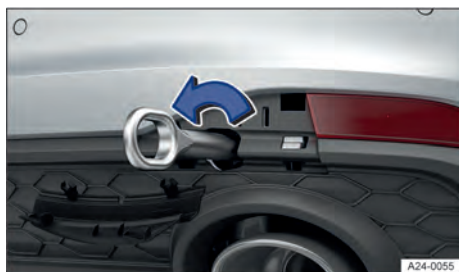
Fig. 161 No para-choque traseiro à direita: rosquear a argola de reboque.
