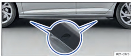
Fig. 187 Na longarina lateral: marcações dos pontos de apoio do macaco (variante 2).
