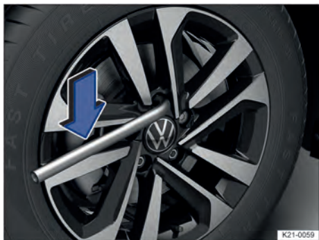
Fig. 192 Remover os parafusos de roda com a chave da roda.
