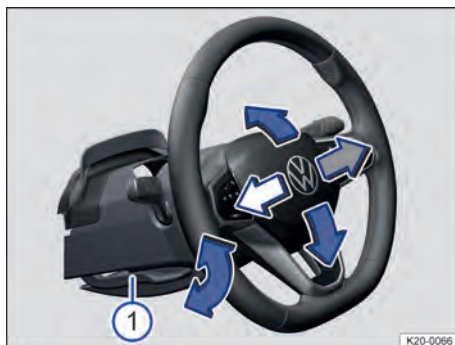
Fig. 59 Embaixo do volante no revestimento da coluna de direção: alavanca de ajuste mecânico da posição do volante (representação esquemática).
