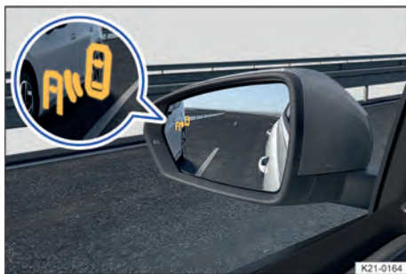
Fig. 116 Nos vidros dos espelhos retrovisores externos: indicador do sensor de “ponto cego”.
