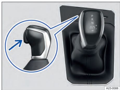
Fig. 95 No console central: alavanca seletora da transmissão automática (representação esquemática).
