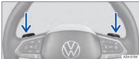
Fig. 97 Atrás do volante: seletores basculantes para o Tiptronic (representação esquemática).
