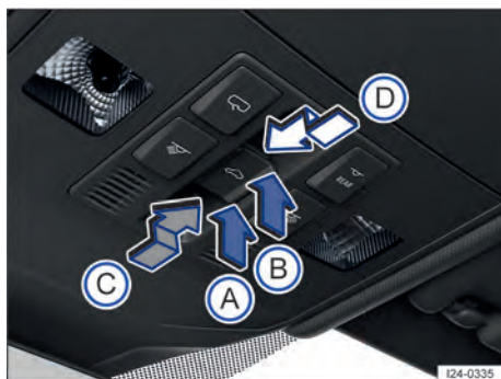
Fig. 58 No revestimento do teto: botão do teto de vidro.
