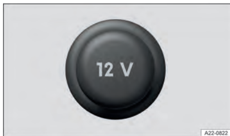
Fig. 127 Na parte inferior do console central: tomada 12 V com cobertura removível (representação esquemática).
