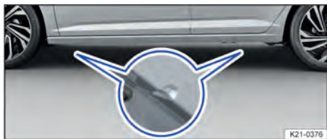
Fig. 186 Na longarina lateral: marcações dos pontos de apoio do macaco (variante 1).
