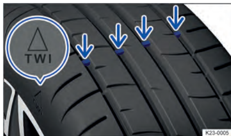
Fig. 180 Nos sulcos do perfil: indicador de desgaste.
