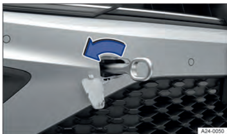
Fig. 156 No para-choque dianteiro à direita: rosquear a argola de reboque da variante 1.
