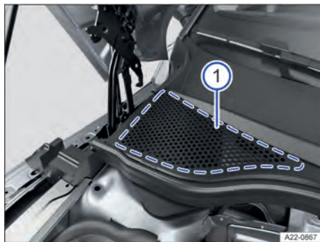
Fig. 202 Entre o compartimento dianteiro e o para-brisas: caixa coletora de água (representação esquemática).
