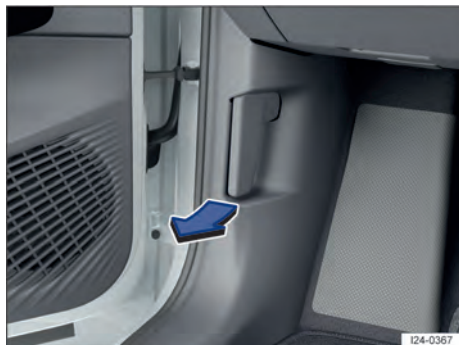
Fig. 162 Na área para os pés no lado do condutor: alavanca de destravamento da tampa dianteira (representação esquemática).
