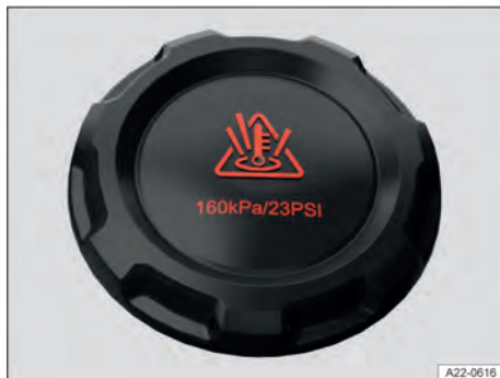
Fig. 171 No compartimento dianteiro: tampa do reservatório de expansão do líquido de arrefecimento (representação esquemática).
