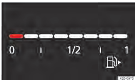
Fig. 14 No instrumento combinado digital Basic: indicador do nível de combustível (representação esquemática).
