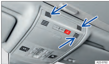
Fig. 54 No console do teto: sensores do monitoramento do interior do veículo (setas).
