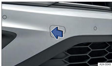
Fig. 155 No para-choque dianteiro à direita: desmontar a cobertura da variante 2.
