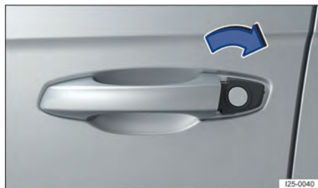
Fig. 51 Maçaneta da porta do condutor: fechamento de emergência.
