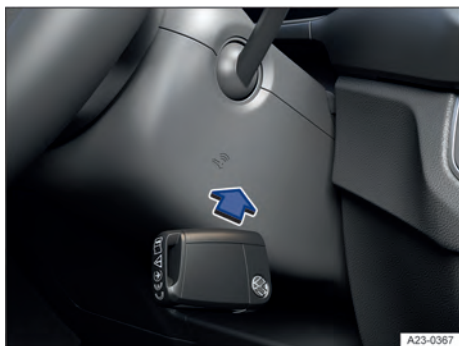
Fig. 92 À direita na coluna de direção: função de partida de emergência em veículos com sistema de travamento e de partida Keyless Access sem chave (representação esquemática).
