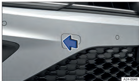
Fig. 154 No para-choque dianteiro à direita: desmontar a cobertura da variante 1.
