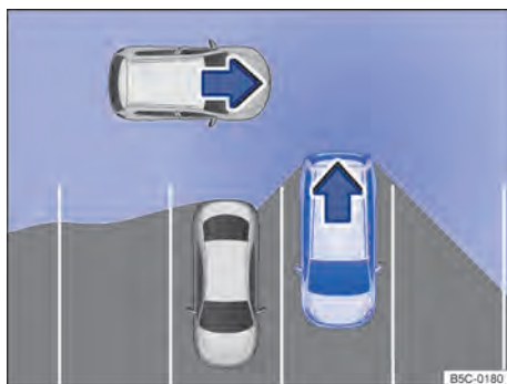
Fig. 122 Área monitorada ao redor do veículo que irá sair da vaga de estacionamento (representação esquemática).
