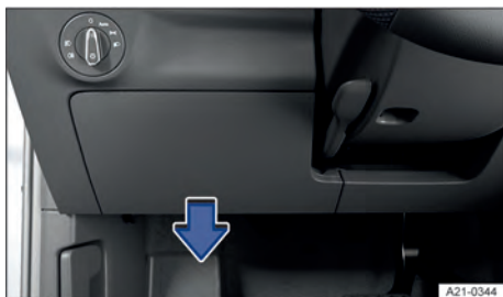
Fig. 147 À esquerda do volante: cobertura da caixa de fusíveis no painel de instrumentos.
