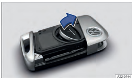
Fig. 46 Chave do veículo: trocar a pilha-botão.
