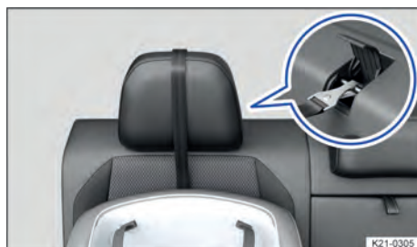
Fig. 38 No encosto do banco traseiro: posição do cinto de segurança no caso de apoios para cabeça não ajustáveis com cinto individual Top Tether.
