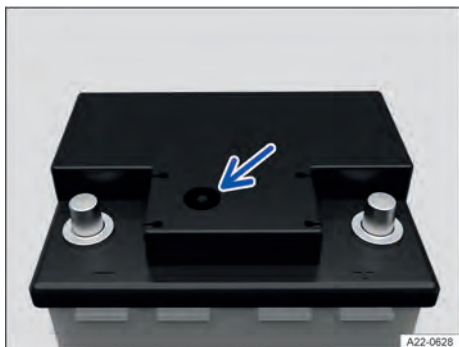
Fig. 174 No lado superior da bateria do veículo 12 V: visor de inspeção da bateria (representação esquemática).
