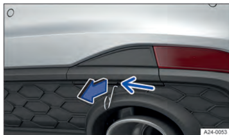
Fig. 160 No para-choque traseiro à direita: remover cobertura.
