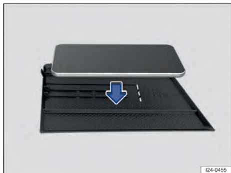
Fig. 128 No console central: tapete de revestimento permeável ao ar da função de carregamento sem fio (representação esquemática). A potência de carregamento é de 15 W.
