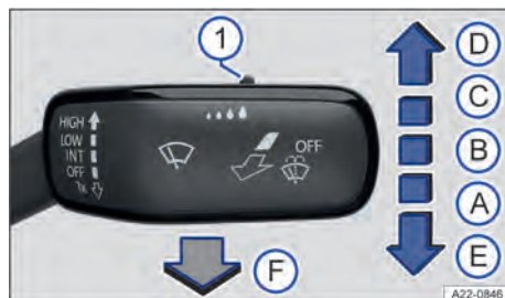
Fig. 81 À direita da coluna de direção: comandar os limpadores do para-brisa.
