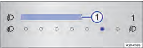
Fig. 80 No sistema Infotainment: regulador tátil para regulagem do alcance do farol.
